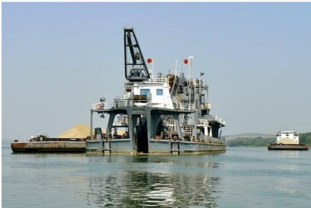
Снимка 1: Изземване на наносни отложения с многокофова дълбачка
